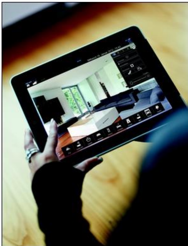
Obr. 5. Ovládání pomocí dotykového panelu Hager Domovea
