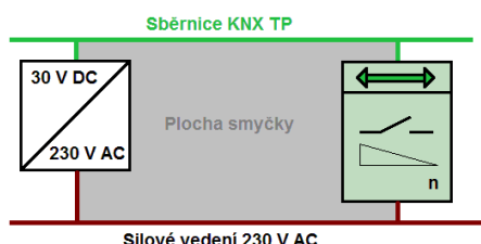
Obr. 9: Smyčka vytvořená silovým vedením a sběrnici
