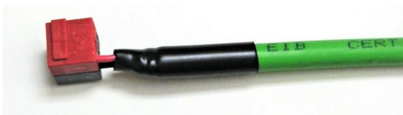
Obr. 2: Konec sběrnice kabelu opatřený smršťovací návlačkou a sběrnice svorkovnicí
